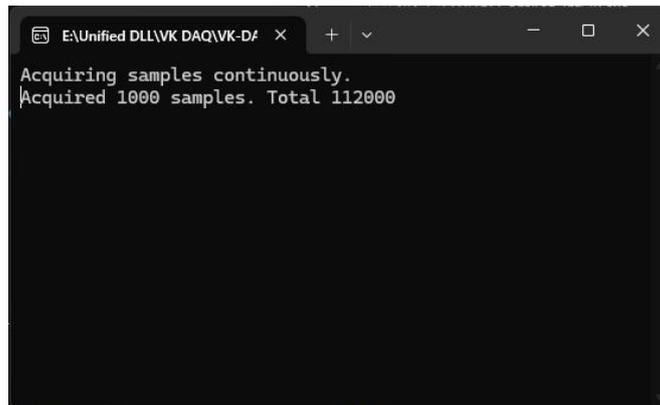
开始运行后，会弹出命令行界面，可以看到 Total 的数值在持续增长，即表示采集卡正在使用内部使用进行连续采样。
